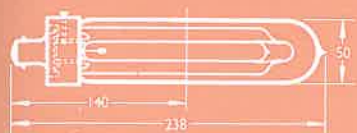
45w. Sodium Vapour
