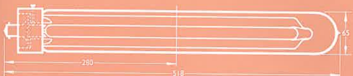
140w. Sodium Vapour
