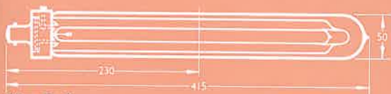
85w. Sodium Vapour
